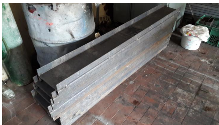
Imagen 28. Unidades de la estructura metálica para el puente.
